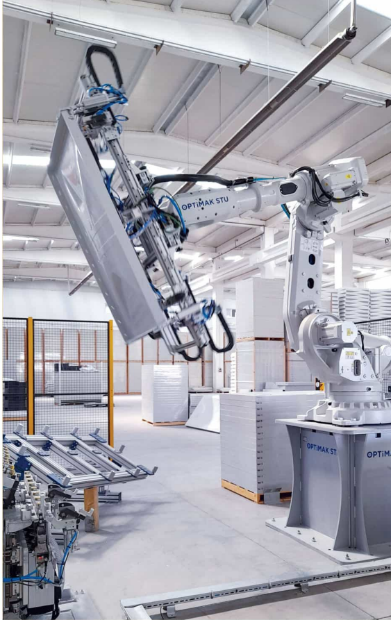
GRP - KOMPOZİT PANEL ROBOTİK DELME
